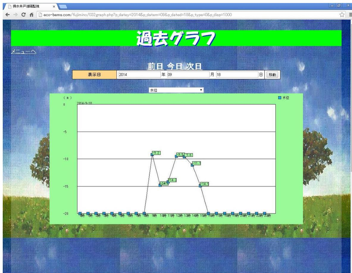
過去グラフは指定日の1時間ごとの各測定値をグラフ化したものです。グラフ表示する項目は、水位、流量、pHおよび六価クロムのなかから選択できます。初回は六価クロムが選択されます。グラフ表示エリアの上部にある選択ボックス（コンボボックス）を操作することにより表示項目を選択することができます。（上記のグラフは「水位」の過去グラフです）
