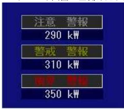
「注意」「警戒」「限界」の各警報の現在の条件が表示(例えば、290kW,310kW,350kW)されていて条件変更は、「設定」メニューの「警報条件設定」で変更することができます。
